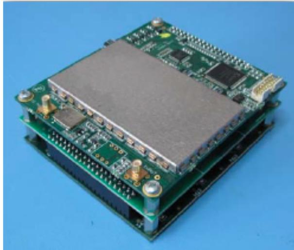
FIGURE 4.4 – Récepteur FOTON proposé par Austin Satellite Design
