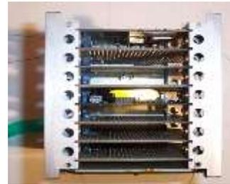
Des barres de séparation se trouvent aux quatre coins du CubeSat 3U. Elles permettent d'éviter tout contact entre les composants du Cubesat et les parois intérieures du P-Pod. En effet, les composants pourraient, dans un tel cas, se détériorer. Elles permettent également l'empilage des composants. Ces barres doivent avoir une épaisseur minimum de 8,5mm. La rugosité de leur surface ne doit pas être plus élevée que 1,6 micromètre.
