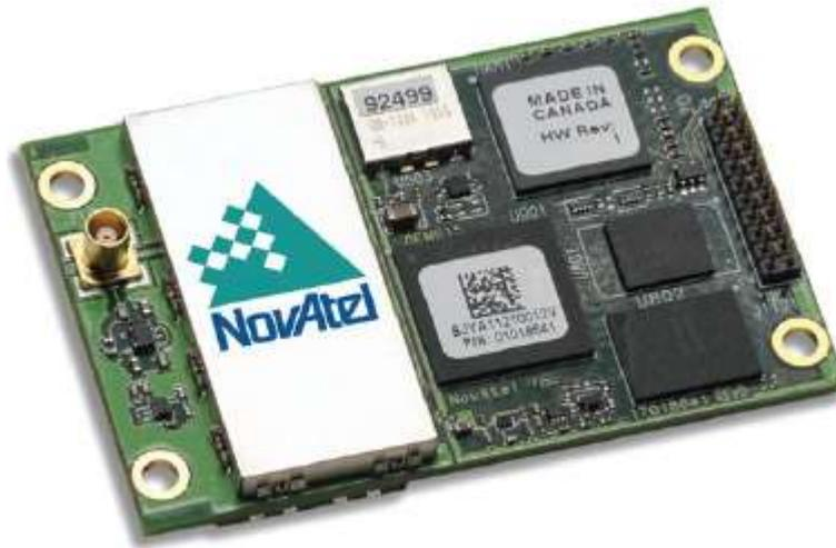
Il s'agit d'un récepteur GPS qui contient 12 canaux, 2 fréquences, avec une grande précision de mesure, et qui peut être relié à une antenne extérieure.
