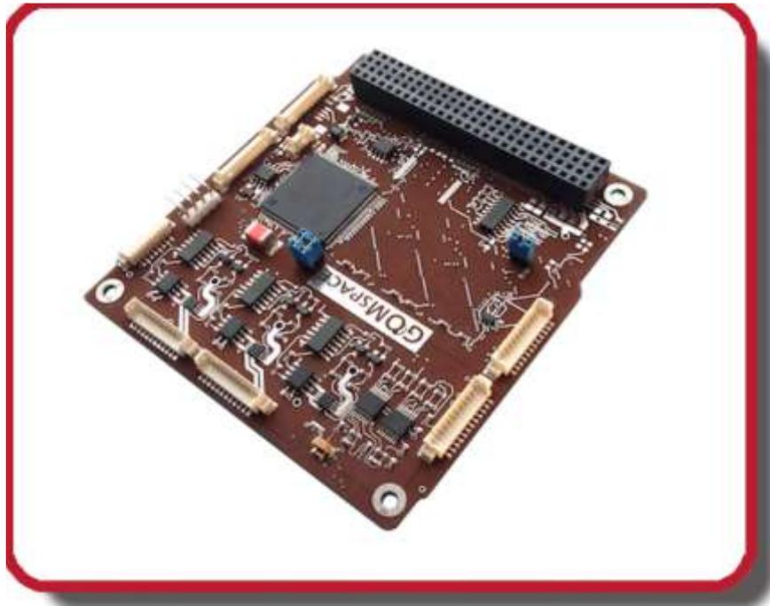
L'ordinateur de bord **NanoMind A712D** est conçu pour les applications critiques. Les applications cibles de l'ordinateur de bord sont des systèmes de traitement de données et des systèmes de télémétrie embarqués. Le **NanoMind** permet de stocker le logiciel de traitement de données et l'application de l'utilisateur. Son interface principale avec tout autre matériel du sous-système est un bus CAN et un bus I2C. Dans cette version, le **NanoMind** fournit un système de détermination d'attitude.
