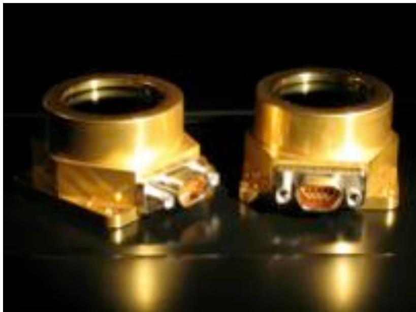
*Figure 7.3.1 - Capteur solaire Sinclair SS-411.*
