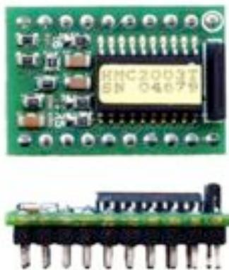
*Figure 9.1.1 - HMC2003 Magnétomètre*
